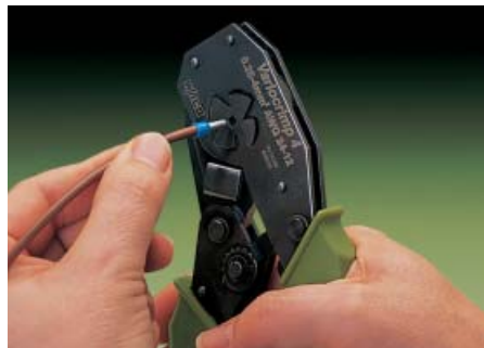
Вставить проводник с наконечником в обжимающую цангу.
