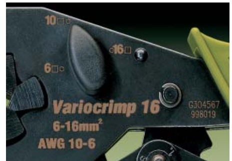
Только для Variocrimp 16: Настройте открытый инструмент на требуемое сечение провода.
