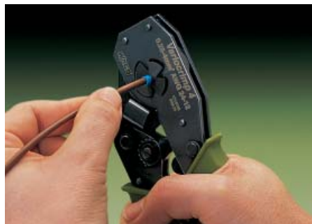
Сжать ручки до освобождения храпового механизма.
